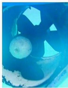
Die abgescherten Propellerschaufeln und die defekte Steuerbox des QUICK Bugstrahlraders
