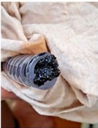
Das „Corpus Delicti“ ist gefunden. Ein grosser Pfropfen von Wasser und Diesel hat das Ansaugrohr verstopft.
