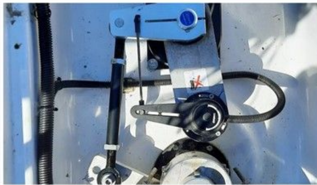
Der Jefa Autopilot ist defekt. Ist es die Kupplung?
