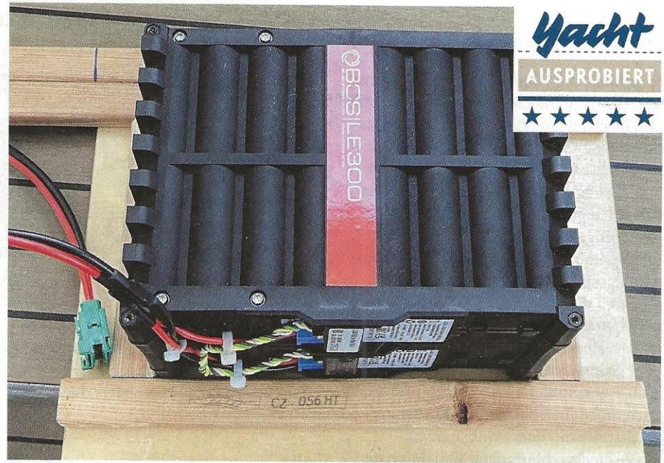
ist simpel. Die mitgelieferten Kabel inklusive Sicherung und Sicherungshalter werden einfach zur bestehenden Batteriebank parallel geschaltet. Während der Testphase wurde dank der LE300-Akkus nicht ein einziger Zyklus der Gelbatterie verbraucht. Alle Ladezyklen übernehmen die Lithium-Module. Um diese überwachen zu können, haben wir noch einen zusätzlichen Shunt in das System eingebunden.
