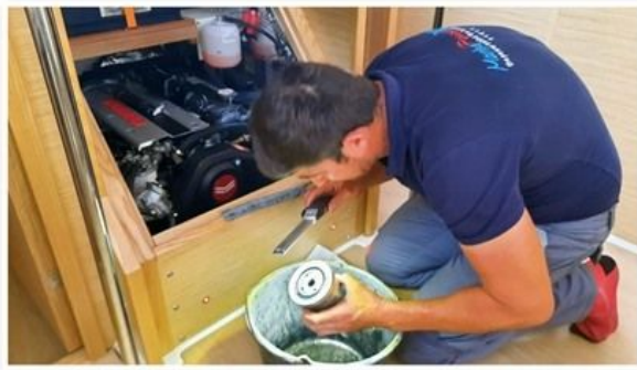
... und der Mechaniker untersucht mit mir die Wasserrückstände im Diesel.
