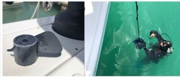
Alle drei Blätter sind abgerissen. Nico der Profitaucher tauscht den Propeller im Wasser
