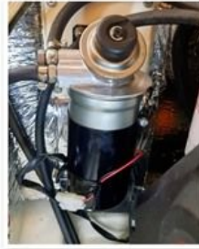
Der Wasserabscheider des Dieselfilters schlug Alarm.
