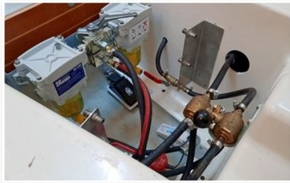
Unsere neue Diesel-Doppelfilteranlage zur Vermeidung von Motorausfällen.
