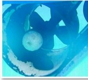
Das Bugstrahlruder mit dem defekten Propeller (links)
