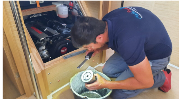
... und der Mechaniker untersucht mit mir die Wasserrückstände im Diesel.
