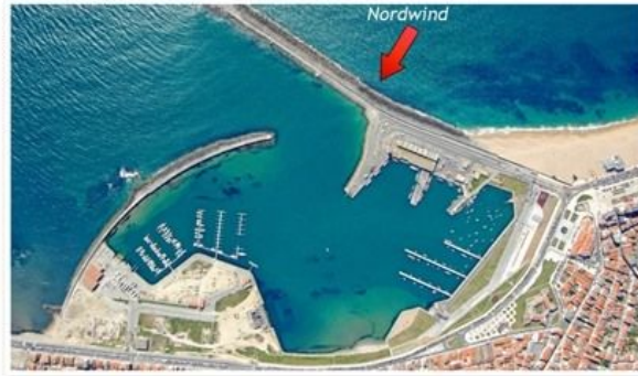
Marina Pavoia de Varzim sieht aus der Luft gut aus, ist aber bei Nordwind (Pfeil) wegen dem grossen Hafenbecken gefährlich bis unbrauchbar.
