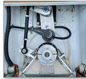
Der Autopilot (oben) mit der Steuerstange zum Ruderquadrant. Ohne ihn ist man ziemlich verloren.
