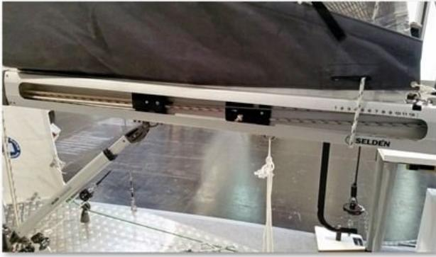
Das ausgeklügelte Reffsystem von SELDEN mit Übersetzung im Baum.
