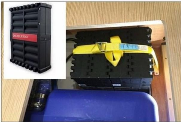
Das Lithium Batterypack ist unter dem Sofa neben dem zusätzlichen Wassertank montiert.
