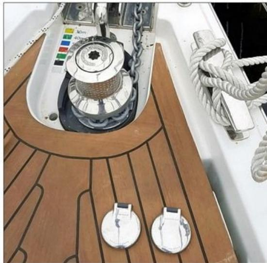
Die Fusschalter erleichtern die Handhabung. Eine Farbmarkierung erleichtert die Kontrolle beim Abfieren der Kette.
